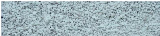
**Perlite:** Vulkanisches Gestein. Verbessert die Strukturstabilität, Wasser- und Luftkapazität von Substraten.
